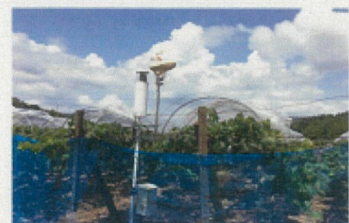
圃場に設置された気象観測等装置
