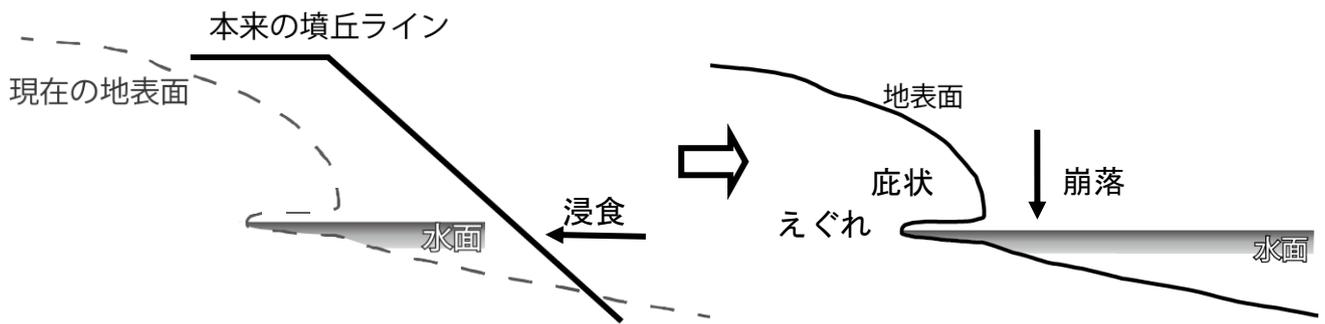
図3 墳丘裾の崩落過程 模式図
