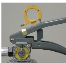
× 安全栓の抜けかけ
