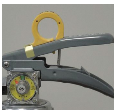
× レバー支えの脱落
