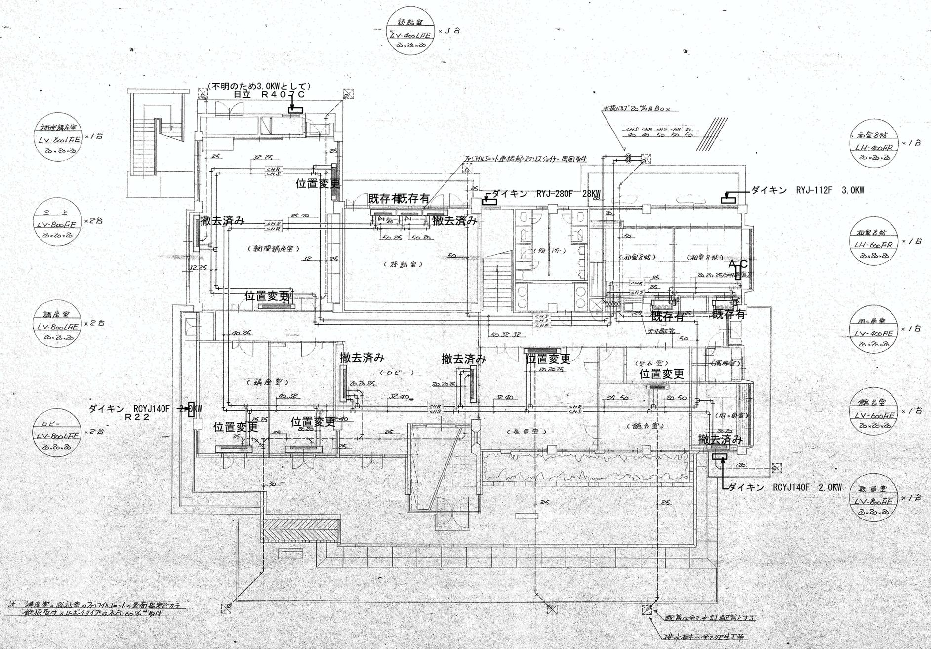
註 講義室・読書室の天井裏に空調管を配管し、配管途中に水漏れ発生し、止水工事を実施しました
